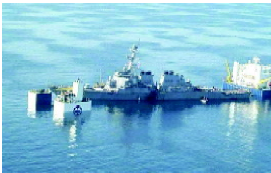
图5 半潜船潜装作业方式示意图
