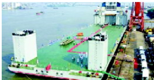
图4 半潜船滚装作业方式示意图
